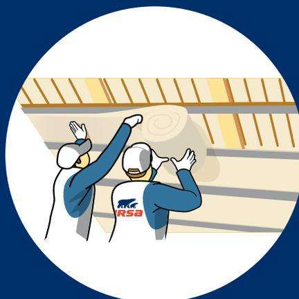
Aplikace minerální izolace URSA PUREONE DF 39 do příčného kovového roštu upevněného na krokve, jako druhá tepelně izolační vrstva. Izolaci vkládáme lehkým vtlačáním po celé délce roštu. Dbejte stejných zásad jako v předešlém aplikačním kroku.
