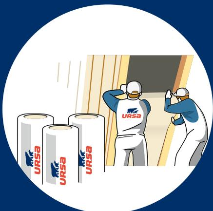
Aplikace minerální izolace URSA PUREONE DF 39 mezi krokve. Izolaci mezi krokve postupně vkládáme lehkým vtlačáním po obou stranách její výšky, až zaplníme celé krokrové pole. K zajištění izolace v krokrovém poli při aplikaci použijte fixační prvky např. drátkování.
