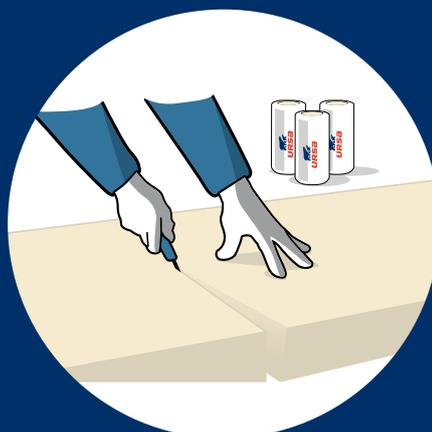
Odřízneme naměřenou část minerální izolace URSA PUREONE DF 39. Řez provádíme podél přítlačné lišty (část OSB desky, kovový profil apod.) speciálním nožem URSA určeným k řezání izolace.
