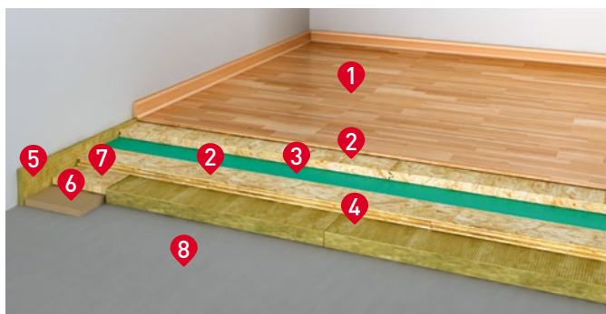
1. Nášlapná vrstva: OSB SUPERFINISH®, vlysy, parkety, PVC, koberec, keramická dlažba apod. / 2. Roznášecí vrstva: 2x velkoformátové desky OSB SUPERFINISH® / 3. Separační fólie (zamezí vrzání) / 4. Akustická izolační vrstva STEPROCK HD / 5. Okrajový pásek STEPROCK / 6. Pásek z dřevovláknité desky šířky 100 mm / 7. Pásek z OSB desky šířky 100 mm / 8. Stropní konstrukce
