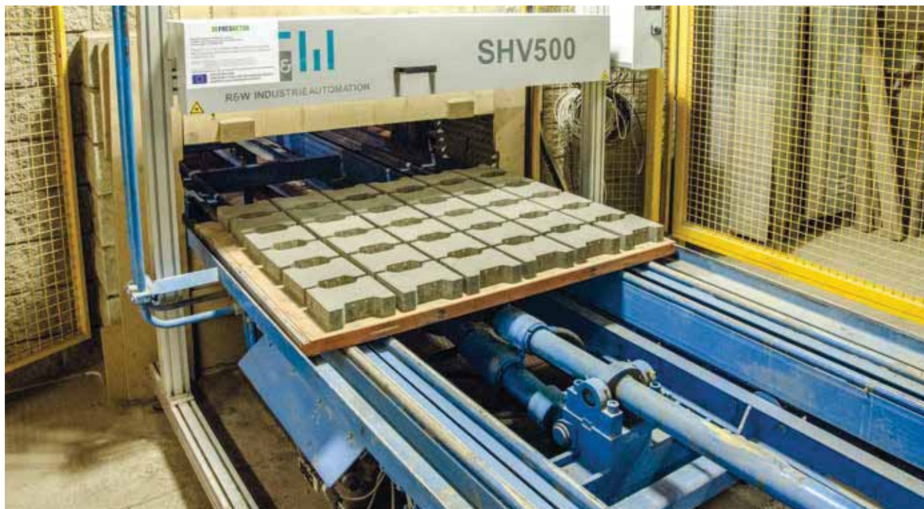
Měřící část kontrolního systému SHV 500
