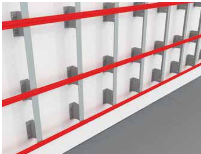
Obr. č. 5 Montáž vodorovného Z-profilu
