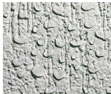
Díky impregnaci PCI Silconal® W odpuzuje fasáda vodu a špínu.
